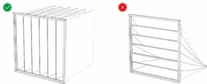
Abbildung 4.4.2.1 Taschenfilter in einer senkrechten Position
