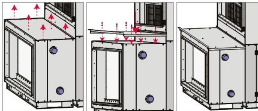
Abbildung 4.10.1.5 Externes Heiz-/Kühlregister Dachmontage für WOWI-AIR-SX-R-H-1500
