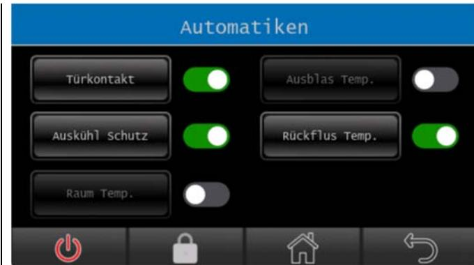
Die Automatiken können mit dem jeweiligen Schiebeschalter aktiviert/deaktiviert werden. Je nach Automatik sind die definierten Parameter wie Temperatur oder Lüfter- und Heizwert einstellbar.
