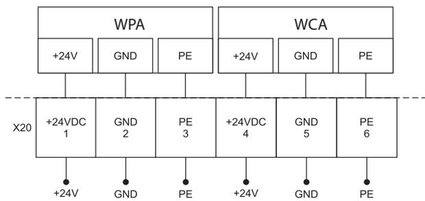
WPA - Stellantrieb für Wasservorwärmer
