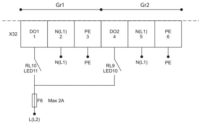
Max. 100 mA/Kanal; Gr1 - Antrieb 1; Gr2 - Antrieb 2
