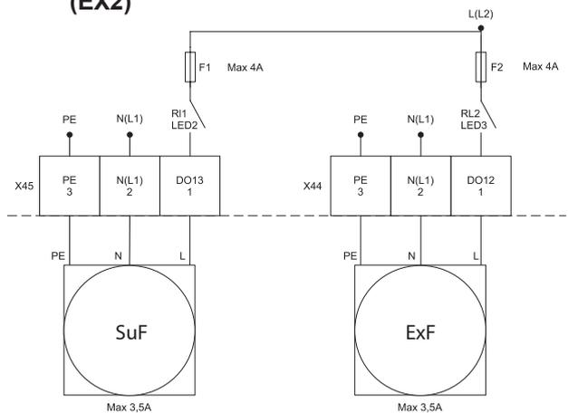
SuF - Zuluftventilator; ExF - Abluftventilator
