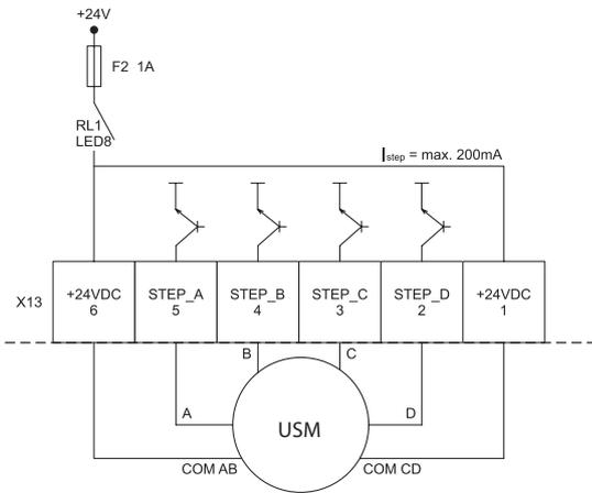
USM - Unipolarer Schrittmotor
