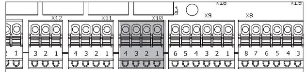
**6.2.9. ANSCHLUSS DER BYPASS-KLAPPE (BYPASS-STELLANTRIEB) (MCB)**
