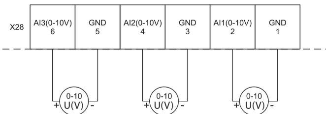
Analog oder PWM (max. 30kHz);  $R_{in} = \text{min. } 8 \text{ k}\Omega$ ; U(V) - Spannung
