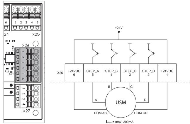
USM - Unipolarer Schrittmotor
