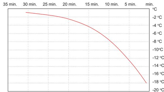
Die Abhängigkeit des Mindestzeitintervalls zwischen den Enteisungszyklen (Minuten) von der Außenlufttemperatur.
