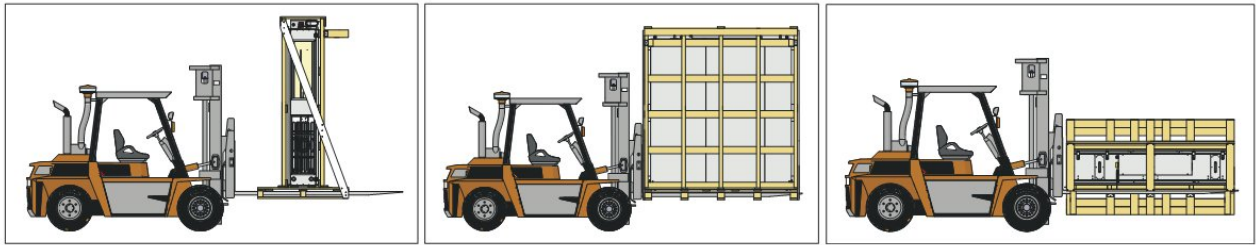
Abbildung 5.2.1. Heben mit Gabelstapler WOWI-AIR-SX-GS-F
