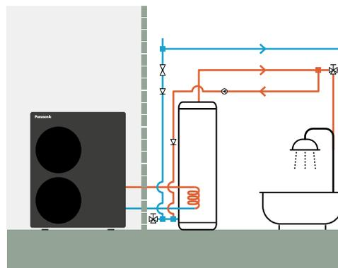
**Während des zeitlich begrenzten Zirkulationsbetriebs wird das Warmwasser in den Leitungen in einstellbaren Intervallen zum Speicher zurückgeführt, sodass immer sofort heißes Wasser für den Nutzer verfügbar ist.**
