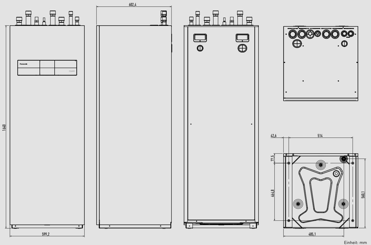
Aquarea Kombi-Hydromodul für Hydrauliksysteme | L-Serie | mit Fremdstromanode
