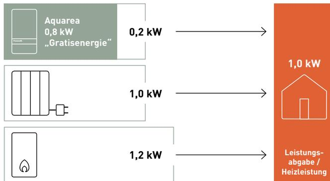
Leistungsaufnahme / Energieverbrauch 1) Bei 35 °C Wasservorlauftemperatur.
