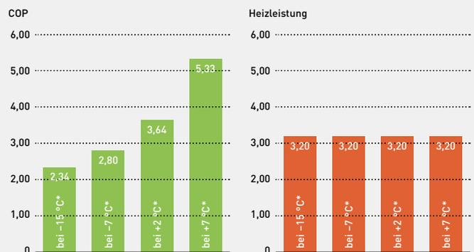
Beispiel: KIT-ADC03K3E5AN bei 35 °C Wasservorlauf Temperatur.
