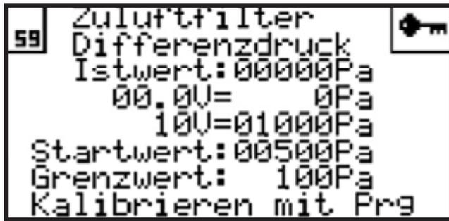
Bei dieser Funktion werden die Filter kontinuierlich auf Verschmutzung überwacht. Sobald Istwert > Start- + Grenzwert wird ein Alarm generiert.
